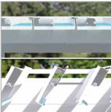
Gecontroleerde waterafvoer ook bij opendraaiende lamel
